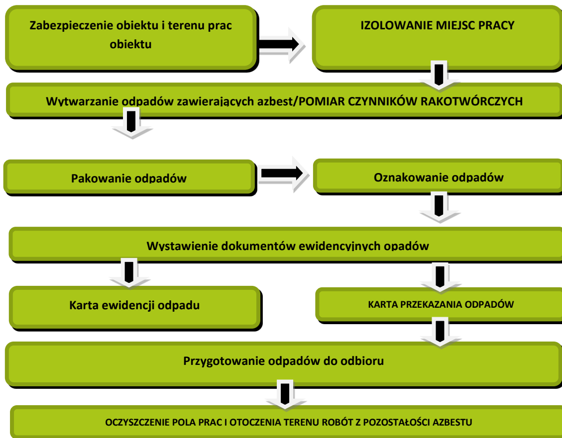
Rysunek 5. Schemat procedury dotyczącej prac polegających na usuwaniu wyrobów zawierających azbest, wytwarzania odpadów niebezpiecznych wraz z oczyszczaniem obiektu/terenu/instalacji.
